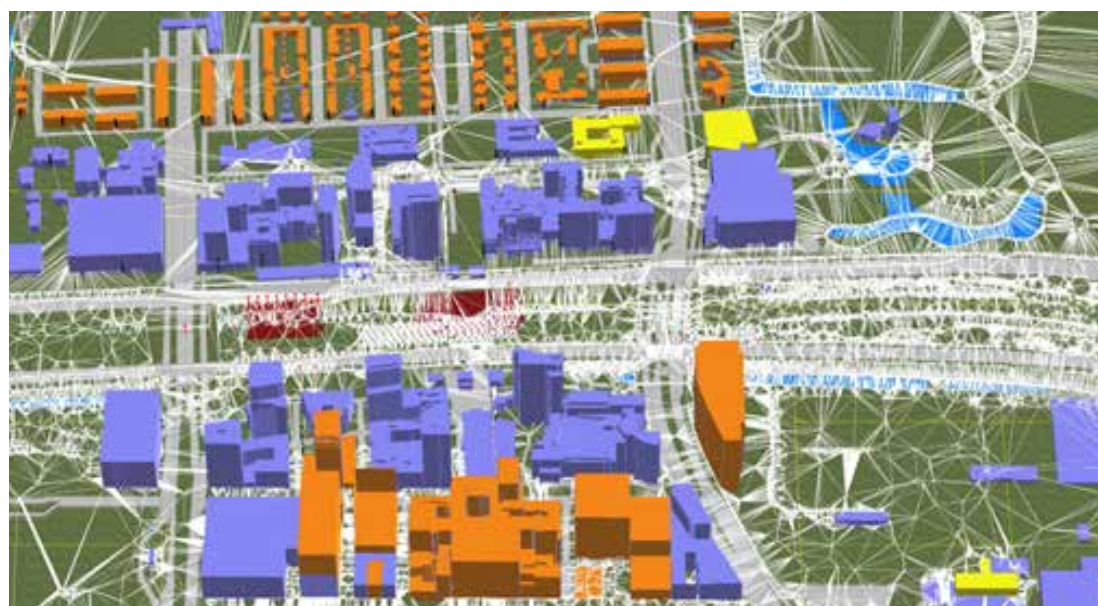
Figuur 2 Weergave 3D-geluidprognosemodel Zuidasdok (Geomilieu v2022.3)
